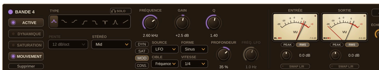
L'onglet MOD : source, cible, forme, vitesse, profondeur et fréquence du LFO
