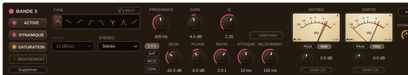
Le panneau de la bande sélectionnée : type, SOLO, fréquence, gain, Q, puis les onglets DYN, SAT, MOD et CONS.
