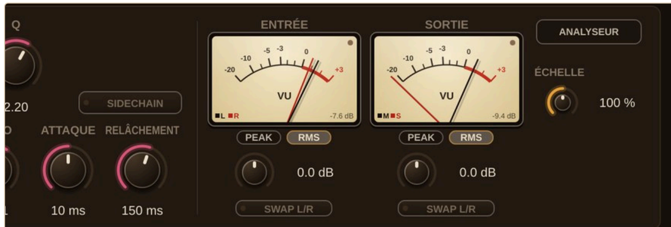
VU-mètres d'entrée et de sortie, PEAK / RMS, SWAP L/R, menu ANALYSEUR et ÉCHELLE
