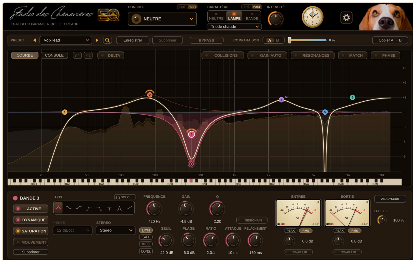
La fenêtre de Chênevrières EQ : en-tête, barre des presets, courbe et panneau de la bande
